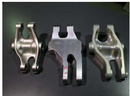
3種類のリンク。左から純正、開発途中の最初のリンク、1098RS用リンク。3種類とも形状、角度が全く異なっているのがわかる。右の1098RS用は純正のスイングアーム、リアサスには使用できないサイズだった。
