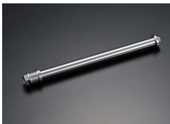
レースから生まれた部品はリアサスリンクだけではない。この特殊鋼熱処理加工ピボットシャフトもそうである。純正のピボットシャフトではパワーに耐え切れず曲がってしまう。それを対策するための強化型ピボットシャフトである。これをつけることにより剛性が高くなり、ライダーはリア周りの感覚が掴みやすくなる。
