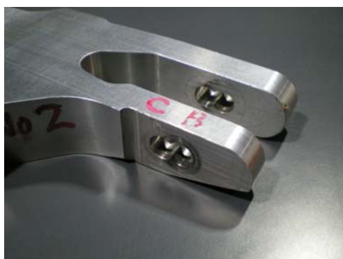
レース中に使用していた開発段階のリアサスリンク。穴位置が2種類設定されテストが行われた。
