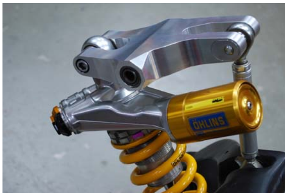
このリンクはJSBに使用したものの。ショートリアサス、ロングスイングアームなどに合わせた専用品であるために、市販車には装着ができない。
