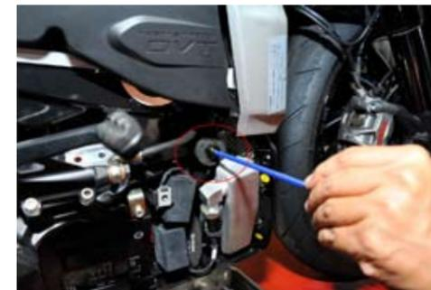
⑥ ラジエター下側のボルトを外します。
